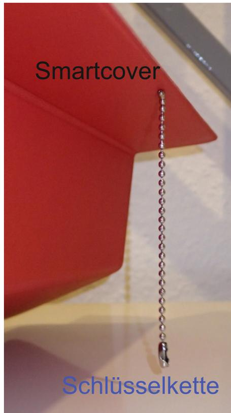
Insbesondere im Smartcover sind sehr viele und starke Magnete integriert. Hier wird zum Beispiel für den Schutz des iPads ein Smartcase verwendet. Durch eine ferromagnetische Schlüsselkette kann man das magnetische Feld sehen und spüren.
